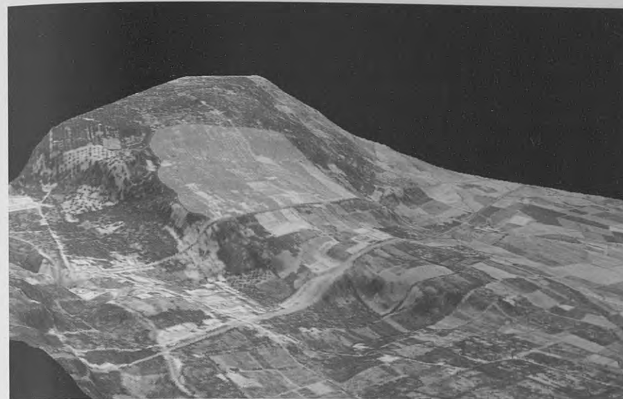
Fig. 2. Pontecagnano (SA). Fotogramma n.11337 strisciata 183B volo WWS, scala media 1:38000 ca., del luglio del 1955 sovrapposto al DTM ( draping ). L'altimetria è accentuata per apprezzare la micromorfologia: si distingue il pianoro dove sorge l'abitato antico.
